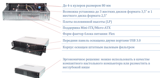
Промышленный корпус IPCWAY Нептун-291-mATX (430x88x291)
