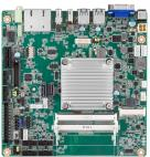
Возможно использование с блоком питания AT/ATX кабель питания приобретается отдельно (1700023082-11 ATX 2\*10P to 1\*3P-2.0 15cm cable)
